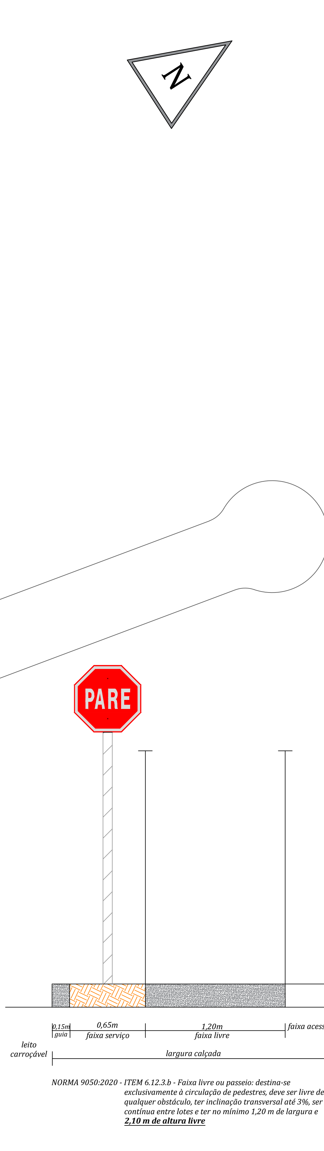
06 Detalhe Altura Livre para Acessibilidade Sem escala
